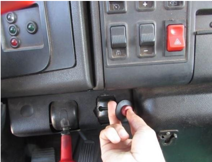
Figura 117 - Colocar a bomba em funcionamento.
