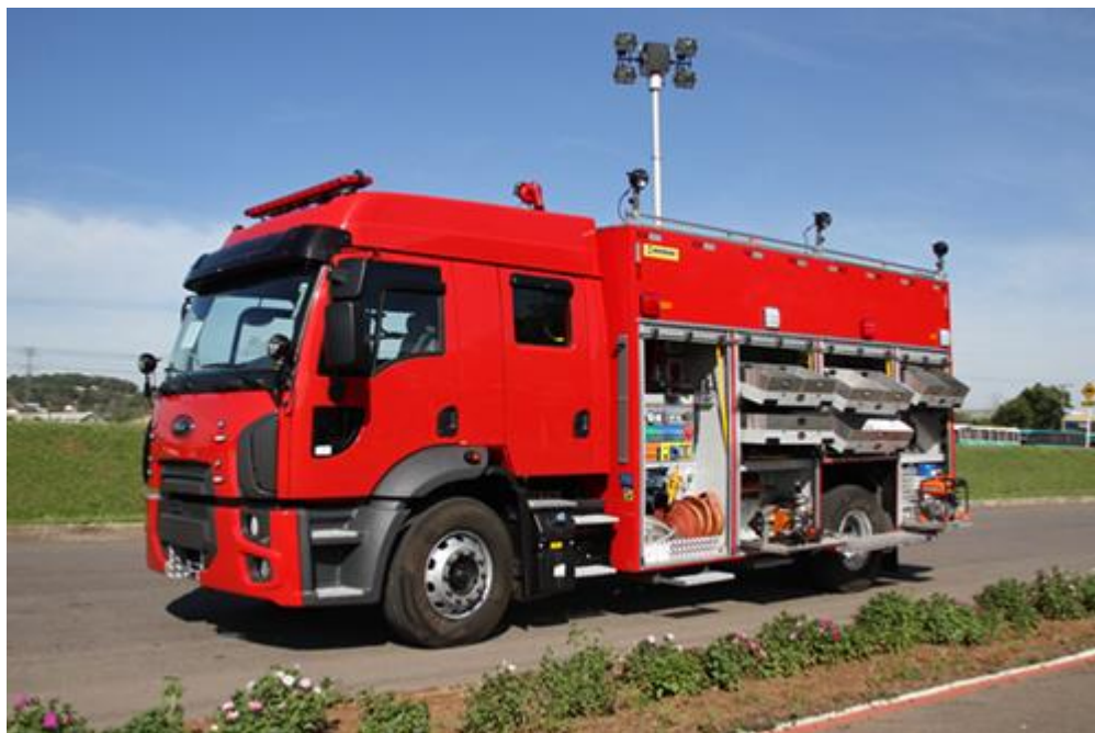
Figura 99 - Torre de iluminação em viatura.
