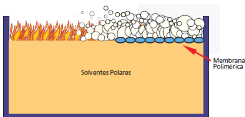
Figura 12 - Atuação da espuma AFFF em álcoois.
