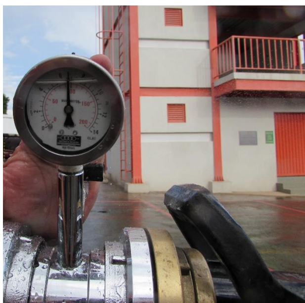
Figura 118 - Teste com medidor de pressão (Mecânica Reunidas) com manômetro calibrado em mangueira de 2 ½"
