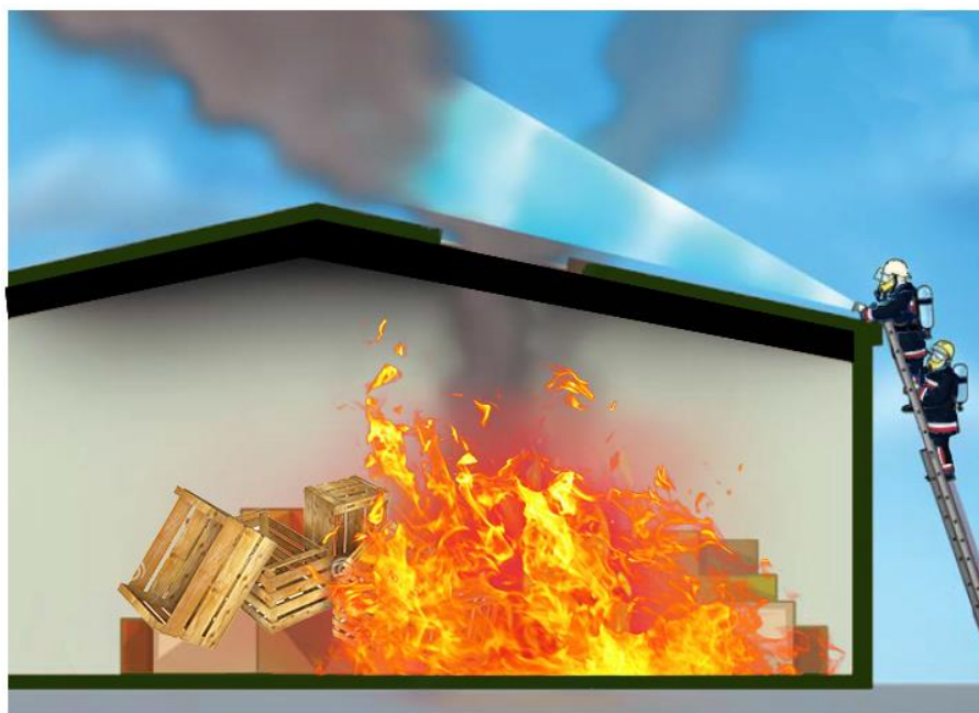
Figura 151 - Jato lançado paralelo à abertura para a saída de fumaça.
