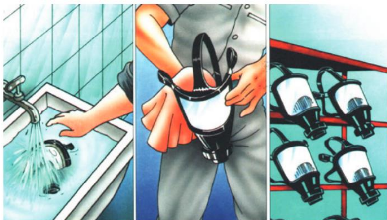
Figura 45- Limpeza da peça facial
