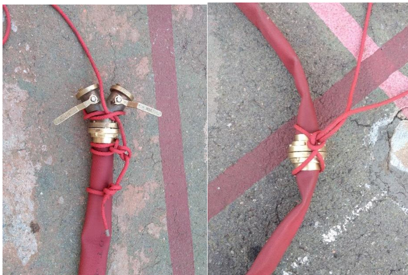
Figura 213 - Amarrações na ligação para içamento
