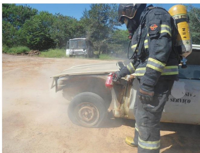
Figura 234 - Primeiro jato, lançado pela fresta do capô
