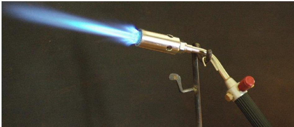
Figura 8 – Chama pré-misturada derivada de maçarico Fonte: http://www.prevencaonline.net/2010/03/operacao-com-macarico.html
