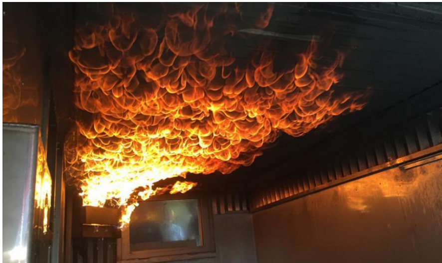
Figura 22 - Presença de chamas na zona de reação. Fonte: http://kupce.ku.edu/kufire-home
