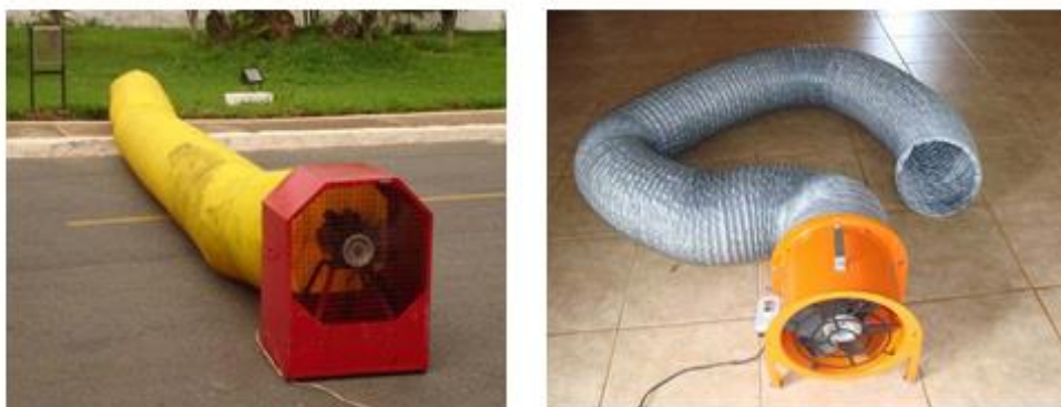
Figura 88 - Exaustores de ar para combate a incêndio.
