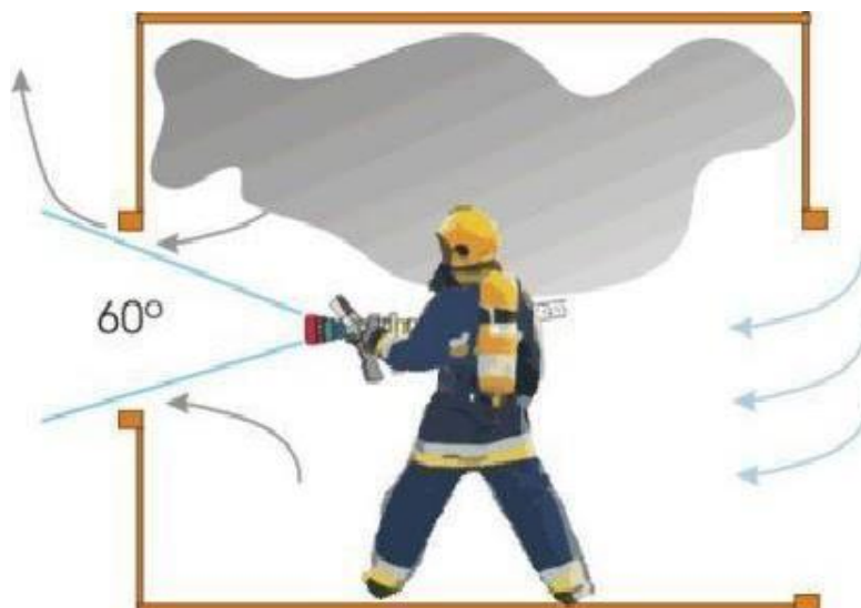
Figura 160 - Posicionamento para ventilação por arrastamento hidráulico
