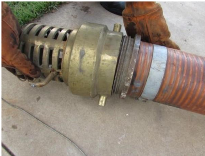
Figura 114 - Na extremidade do mangote inserir o ralo.
