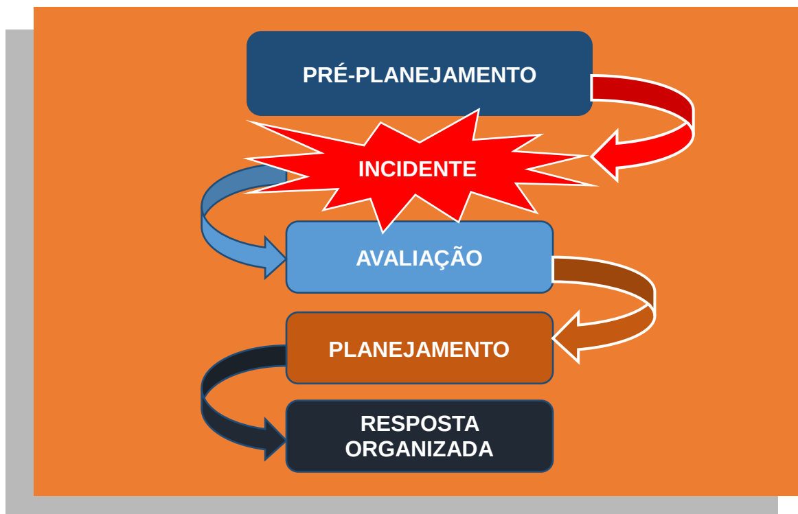
Figura 261 - sequência para resposta organizada em incêndios
