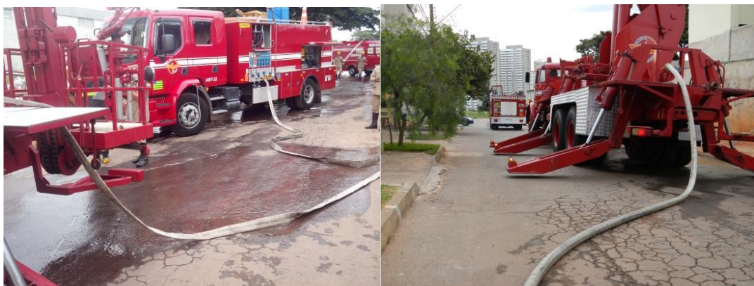
Figura 221 - Adutora do ABT ligada a APA
