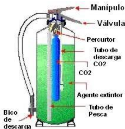
Figura 20 - Componentes do aparelho extintor.
