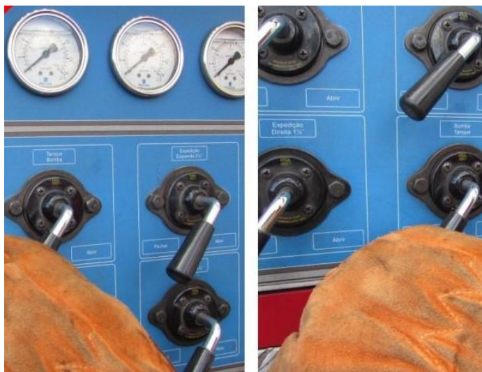
Figura 112 - Fechar todas as válvulas (bomba/tanque e tanque /bomba, expedições, drenos, etc.).
