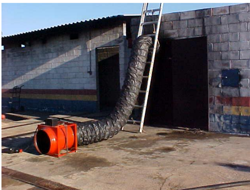
Figura 156 - Posicionamento do exaustor para a VPN Fonte: CBM-SP - MVP, 1ª edição - Página 63
