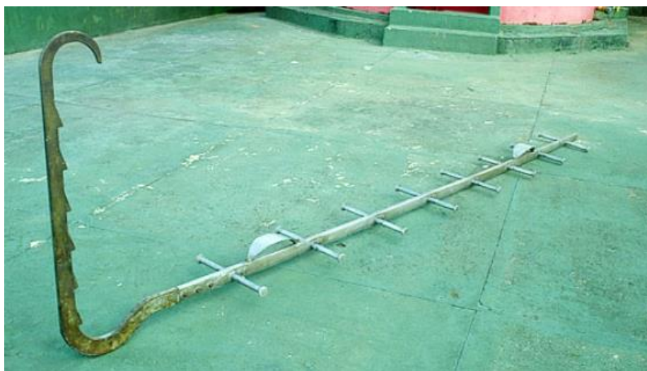
Figura 93 - Escada de Bombeiro.
