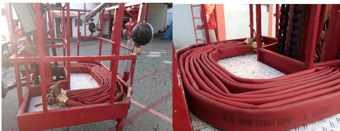
Figura 219 - Ligação conectada ao divisor no cesto da plataforma
