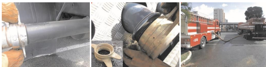
Figura 110 - Conectar AT ao ABT por meio de Mangote de 4' utilizando luva de adaptação no ABT.
