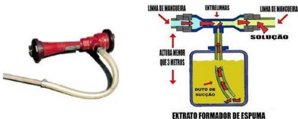
Figura 64 - Proporcionador “entrelinhas” de espuma e seu funcionamento.
